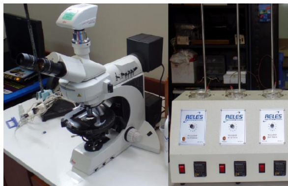
Figura 2. Equipos usados para realizar el conteo de huellas nucleares asociadas concentraciones al Radón 222.
