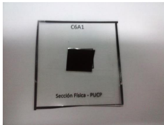
Figura 1.- Detectores de LR 115 utilizados en el monitoreo de Rn 222
