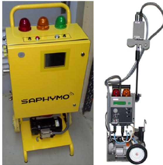
**Figura 1. Equipos para medición continua en aire de partículas  $\alpha\beta$ .**
