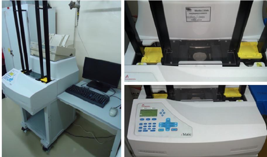
**Figura 3. Equipo de medición de test de superficie  $\alpha\beta$ .**
