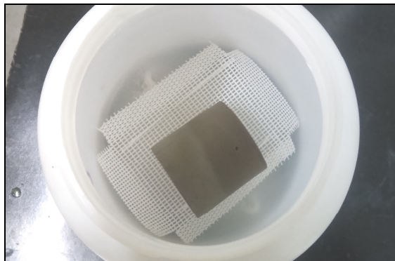
Figura 1. Corpo de prova sendo lixiviado em água deionizada.
