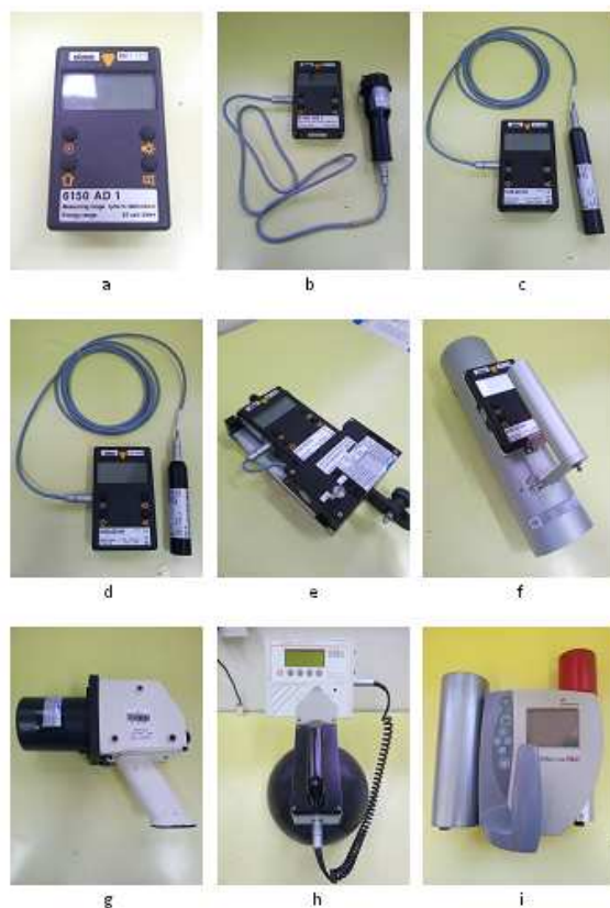
Figura 7: a- Automes 6150; b- Automes 6150 con sonda Automes 6150AD17; c- Automes 6150 con sonda Automes 6150AD18; d- Automes 6150 con sonda Automes 6150AD 15; e- Automes 6150 con sonda Automes 6150AD-k; f- Automes 6150 con sonda Automes 6150AD-b; g- Canberra Babyline 81; h- Berthold 6411 B e i- Canberra Inspector 1000.
