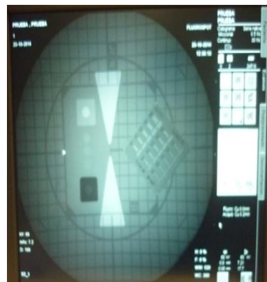
Ilustración 2.- Imagen del maniquí REX en la pantalla del equipo en modo fluoroscopia.
