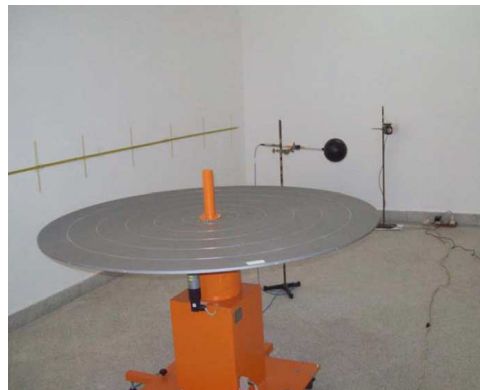
Figura 2. Imagen del irradiador panorámico de ^{137}\text{Cs} , modelo OB36
