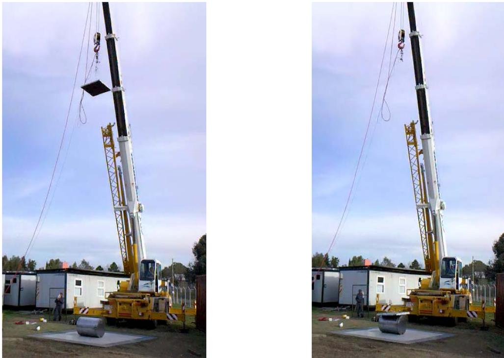
**Figura 3: (Izquierda) Prototipo DALMA 25 posicionado horizontalmente para el primer ensayo de aplastamiento dinámico. (Derecha) Momento del impacto de la placa maciza.**
