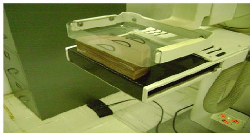
**Figura 2** – O BTE posicionado em contato com a placa de compressão.
