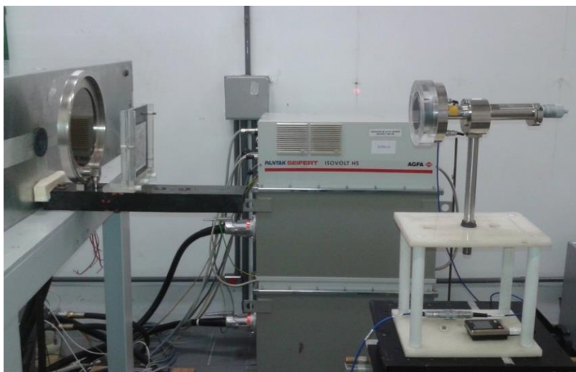
Figura 1. Arranjo experimental para a determinação das primeiras camadas semirredutoras das radiações ISO de baixa energia da série N com a câmara de extrapolação PTW23392.
