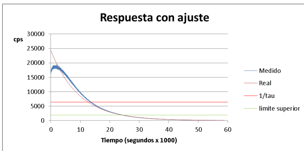
Figura 8 Respuesta del detector con ajuste de los parámetros obtenidos.
