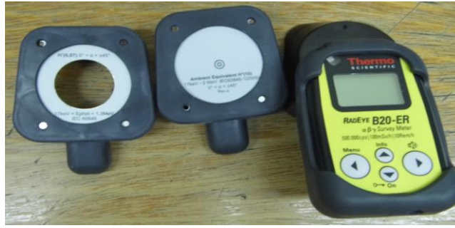
Figura 2 Monitor portátil Thermoradeye B20-ER y filtros asociados.
