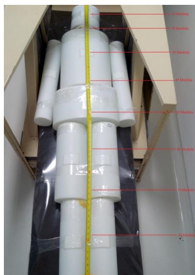
Figura 1. Esquema de posicionamento Detector/Fantoma para as oito posições
