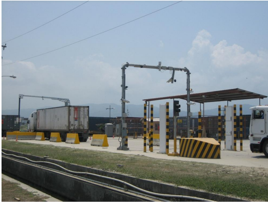
Figura.1. Punto de Inspección de Contenedores. Entre los postes amarillos se encuentran los sistemas de detección de radiación. El portal metálico contiene cámaras utilizadas para el sistema OCR. Finalmente el contenedor pasa por el sistema VACIS de rayos gamma.
