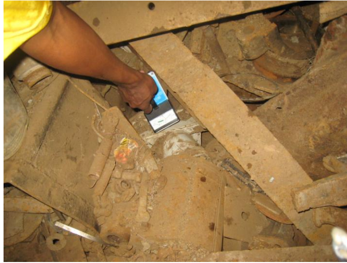
Fig.3. Detección de una de las fuentes radiactivas en interior de un contenedor de cargado de chatarra.
