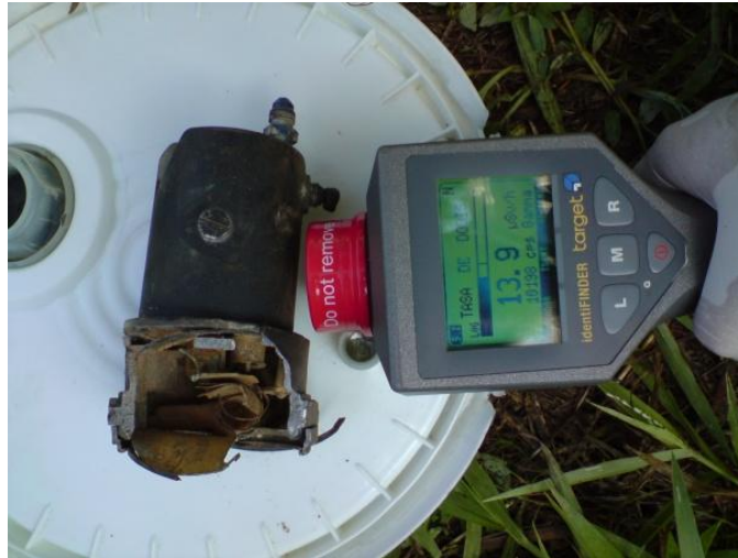
Figura 3. Fuente de Americio241-Berilio detectada en un contenedor exportando aluminio reciclado
