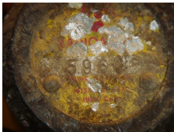
Figura 5. Cara frontal de la fuente de Americio241-Berilio detectada en un contenedor exportando aluminio reciclado.
