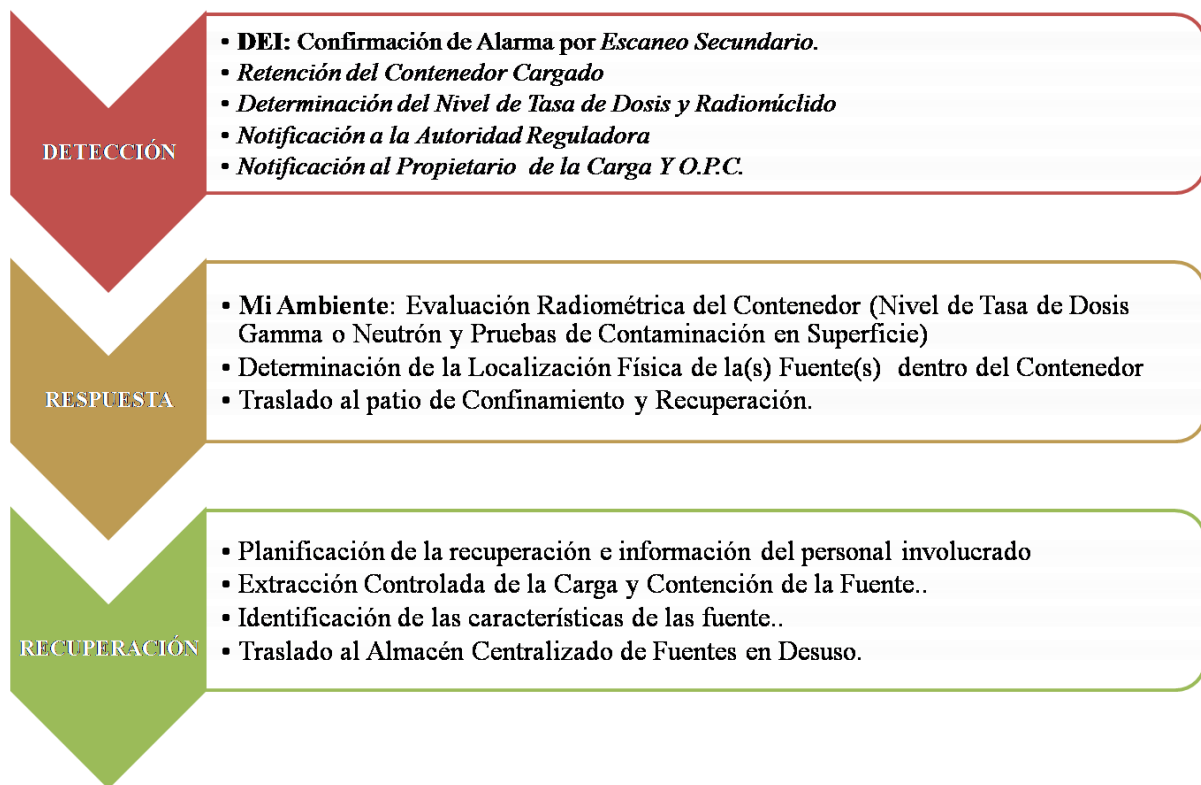
Figura 2. Diagrama del proceso de detección material radiactivo.
