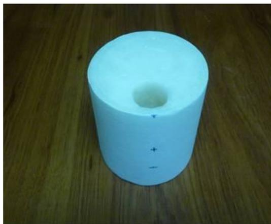
**Figura 1. Maniquí empleado para la calibración cruzada de los sistemas de medición**
