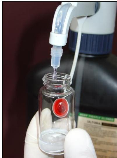
**Figura II: Adição do coquetel Ultima Gold AB Packard no vial de cintilação**
