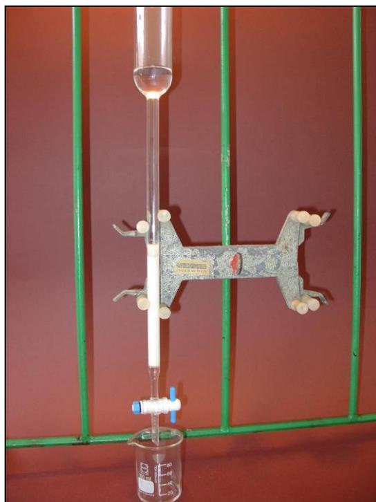
Figura I. Coluna com resina cromatográfica Sr-Spec
