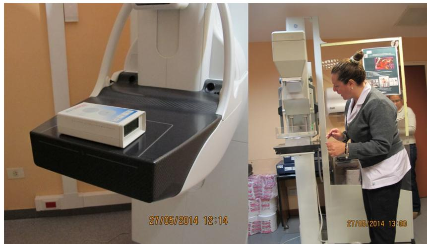
**Figura 1. Multímetro apoyado sobre portadosímetro de un mamógrafo y placa de PMMA con la cápsula TLD.**
