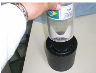
**Figura 1: Simulador de tiroides con inserto de fuente de  $^{133}\text{Ba}$**
