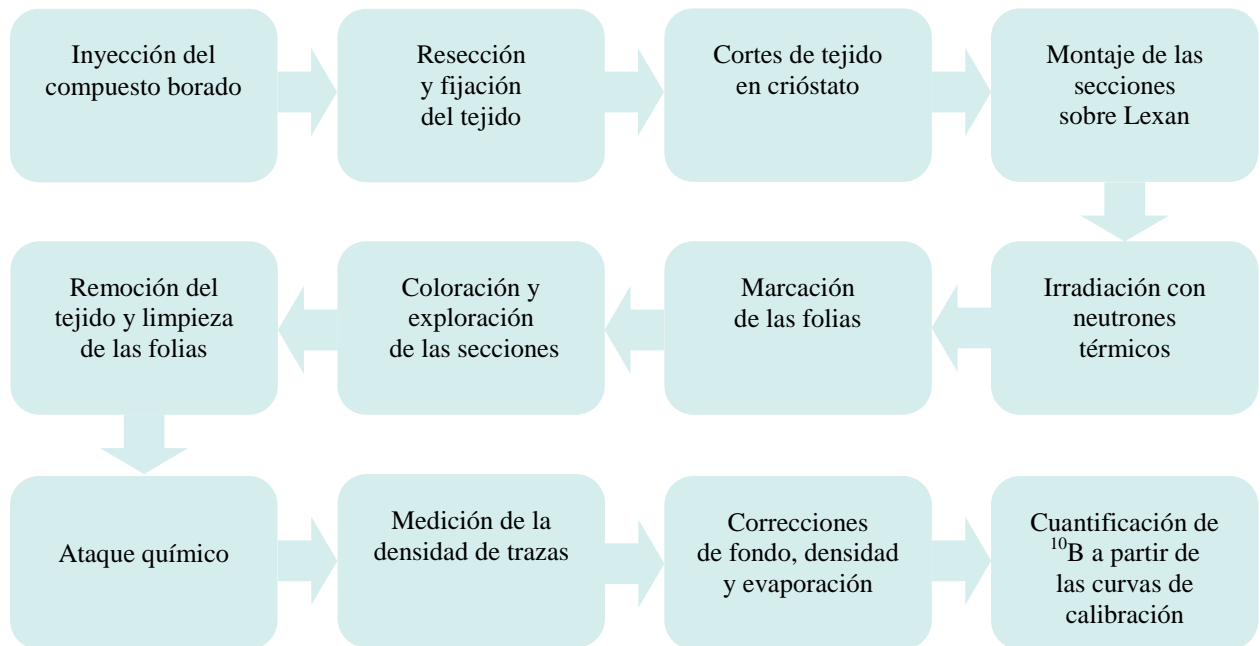
Figura 3. Esquema de la metodología para cuantificar ^{10}\text{B} por AQT.
