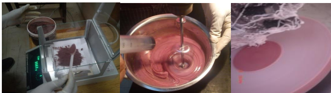
Figura 1. Proceso de construcción del tejido equivalente (agua sólida).
