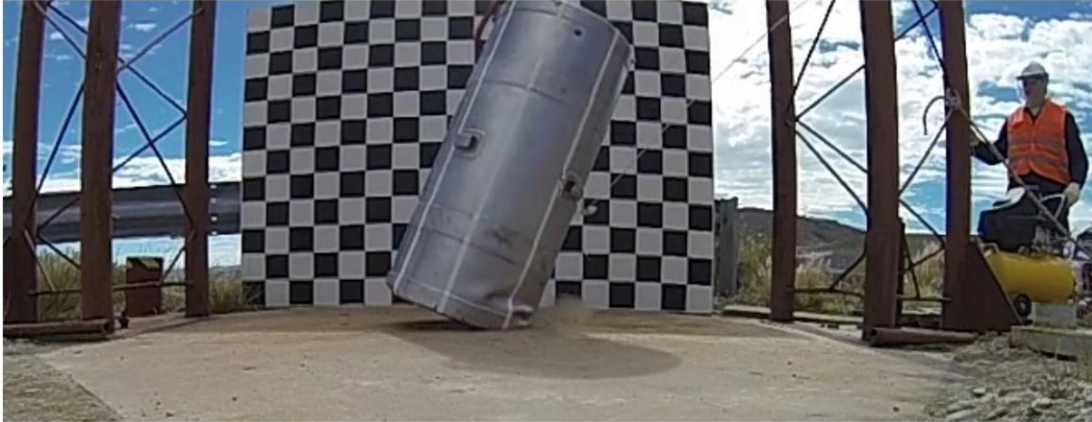
Figura 8. Fotografía post-impacto del ensayo a escala real de caída libre desde 9 m de altura.
