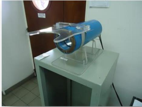
**Figura 1. Detector de INa 3x3 empleado para la medición de  $^{131}\text{I}$  en tiroides**
