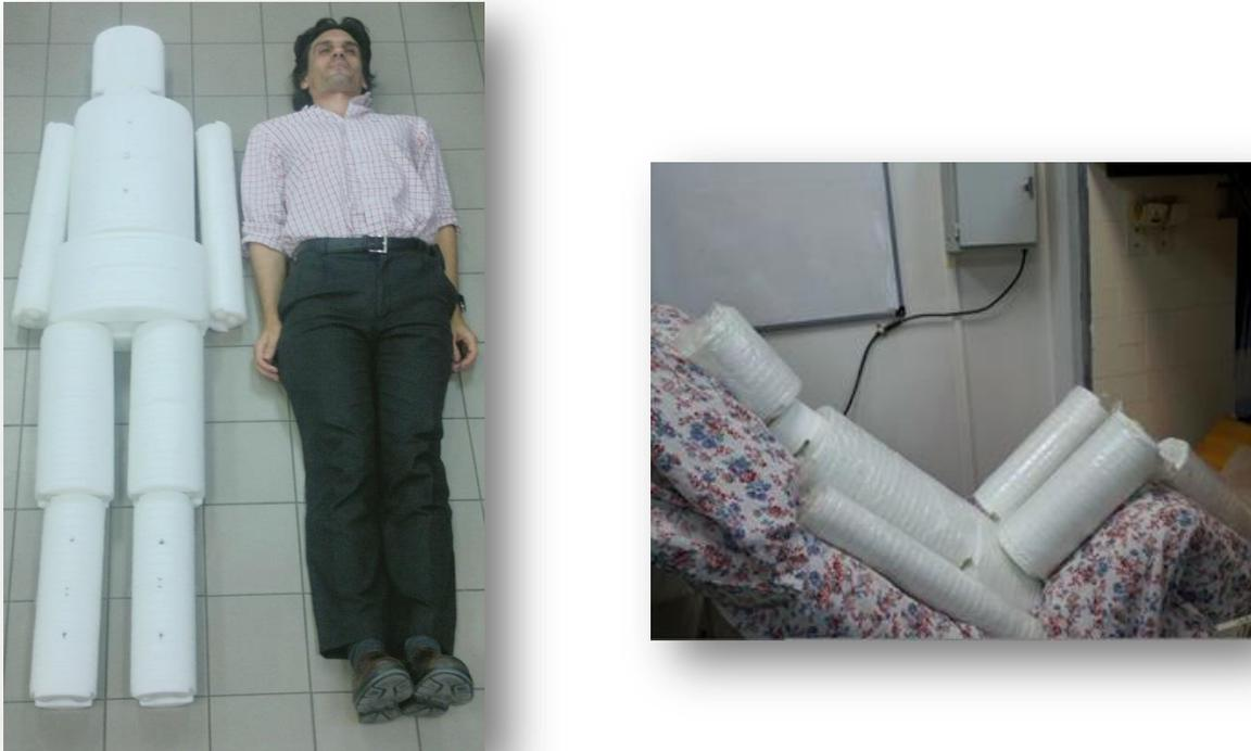
**Figura 3. Maniquí simulador de Todo el Cuerpo comparado con persona (izquierda) y posicionado en la geometría de medición (derecha)**
