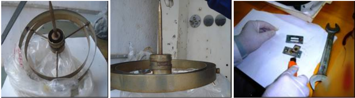
Fig. 8 Desmantelamiento del pararrayos Fair Raythor, modelo Major
