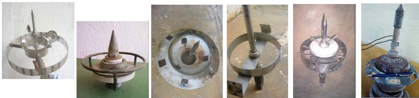
Fig.1. Modelos de pararrayos radiactivos almacenados en las instalaciones de GDR
