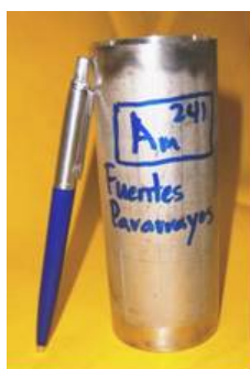
Fig. 3. Contenedor (cápsula) para el almacenamiento de las fuentes radiactivas de los pararrayos
