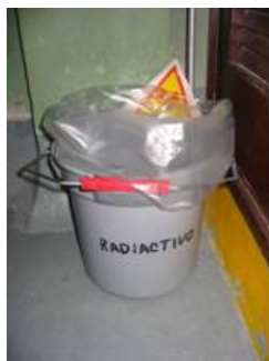
Fig. 4. Contenedor para el almacenamiento de materiales contaminados generados del desmantelamiento de los PR
