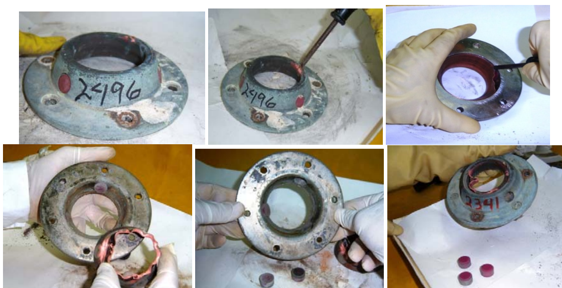
Fig. 6. Desmantelamiento del pararrayos Helita
