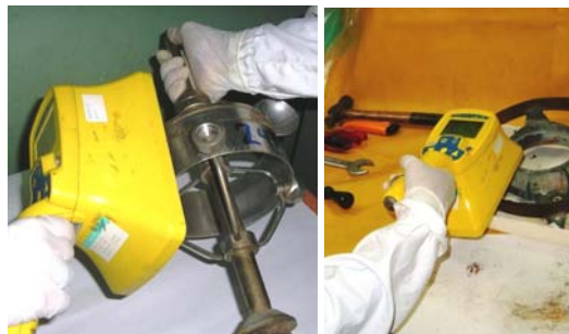
Fig. 10 Monitoreo de los componentes del pararrayos luego de retirar las fuentes radiactivas.
