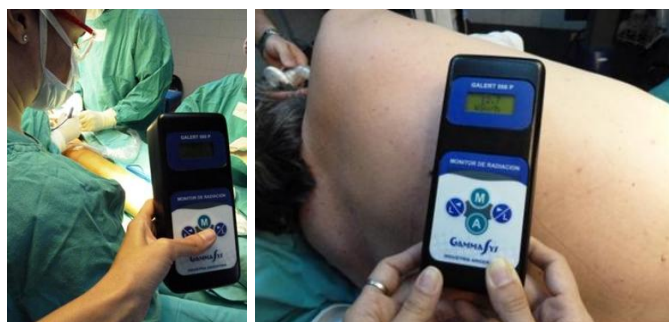
Figura 3 “Medición de taza de dosis en quirófano”
